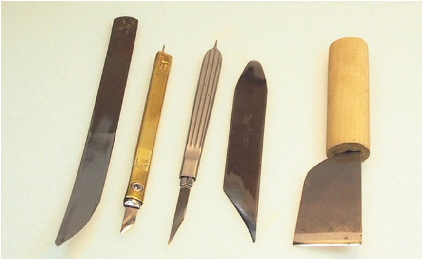
13 – 14 Verschiedene Messer (v. l.): Gebogenes Oberlederschärfmesser; Zuschneidemesser mit kurzer Schneide; Zuschneidemesser mit langer, flexibler Schneide; Schuhmacherkneip; japanisches Zuschneide-Schärfmesser. Rechts: Die Fingerhaltung beim Führen des Zuschneidemessers.
