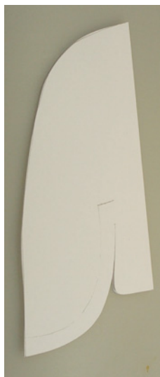
8 – 9 Die Buggzugabe kann entweder am Modell angezeichnet werden (links) oder erst beim Anschneiden des Leders zugegeben werden. Das Papiermodell wird dabei als Orientierung auf das Leder geheftet (rechts).
