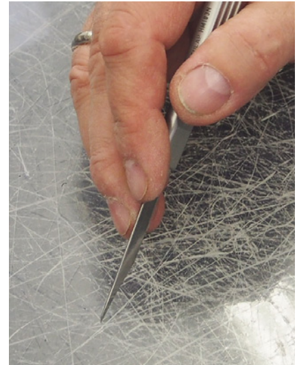
13 – 14 Verschiedene Messer (v. l.): Gebogenes Oberlederschärfmesser; Zuschneidemesser mit kurzer Schneide; Zuschneidemesser mit langer, flexibler Schneide; Schuhmacherkneip; japanisches Zuschneide-Schärfmesser. Rechts: Die Fingerhaltung beim Führen des Zuschneidemessers.
