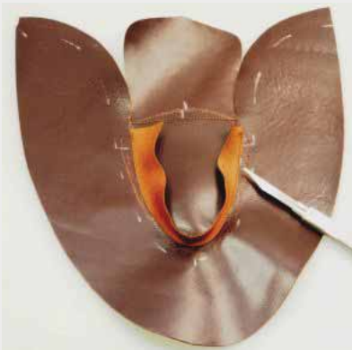
23 Das Oberleder wird im Bereich der späteren Verklebung aufgeraut.
