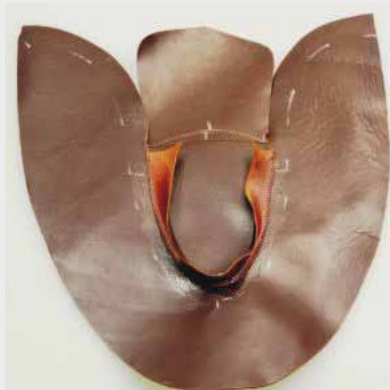
24 Vorderblatt und Lederstreifen werden mit Klebstoff eingestrichen.
