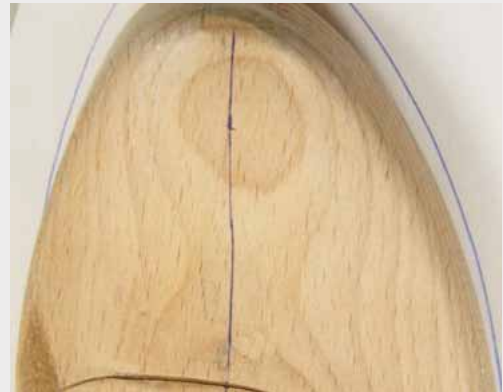
2 Leistenspitze mit Modellpapier und übertragenem Umriss des Leistens.
