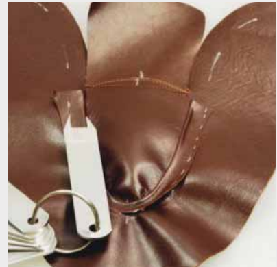
25 Das Oberleder wird nach außen geschlagen und die Breite des Spiegel festgelegt.
