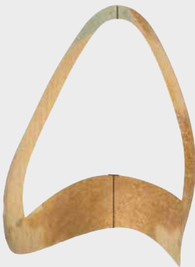
3 Das ausgeschnittene Modellpapier wird zur Kontrolle auf den Leisten gelegt.
