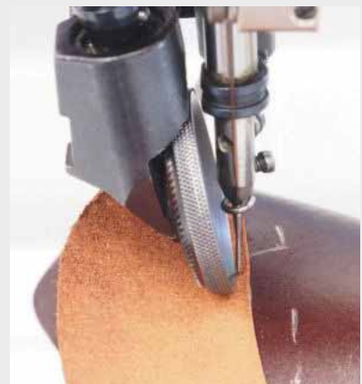
21 Der Lederstreifen wird auf das Vorderblatt genäht.
