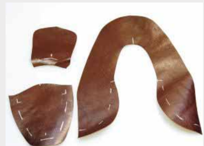
16 Ausgeschnittenes Leder mit aufgezeichnetem Untertritt.
