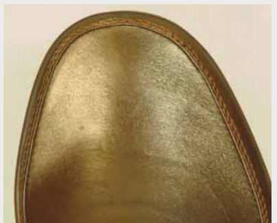
18a Aufgezwickter Schaft mit auf dem inneren Teil des Spiegels aufgesetztem Unterteil.
