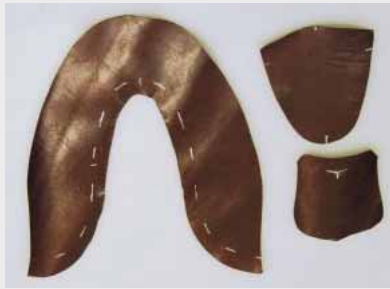
12 Ausgeschnittenes Leder für den aufgesetzten Spiegel.
