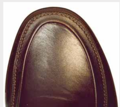
28a Aufgewickelter Schaft mit aufgesetztem Spiegel.
