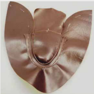
26 Der Spiegel wird entlang der Linie mit dem Vorderblatt vernäht.
