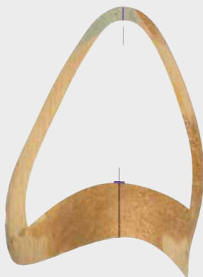
4 Mittellinie und Ballenlinie werden auf das Modellpapier gelegt.
