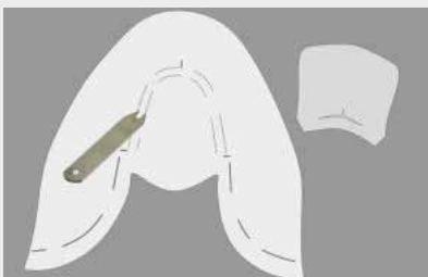
19 Muster, Oberledervorderblatt mit eingezeichnetem Spiegel.
