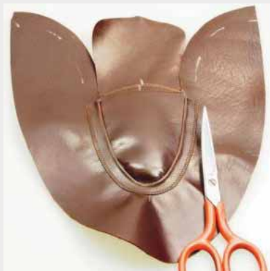
27 Der Lederstreifen wird mit Hilfe der Schere entlang der Naht beschnitten.
