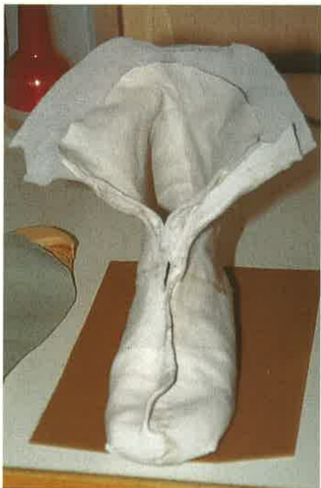
8 Nachdem der Klebstoff ausgehärtet ist, bleibt die Form des Schafts erhalten.
