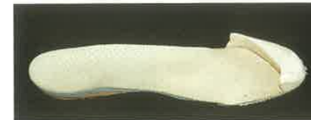
2 Chassis für den Schuh mit Weichbettung und Platzhalter für Längenzugabe. Grundlage ist eine Metallsohle, welche in der Längsrichtung flexibel, in der Querrichtung aber stabil ist.
