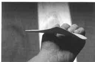
Abb. 5 u. 6: Der Fersenbereich wird bis auf eine dünne Schicht weggeschliffen.
